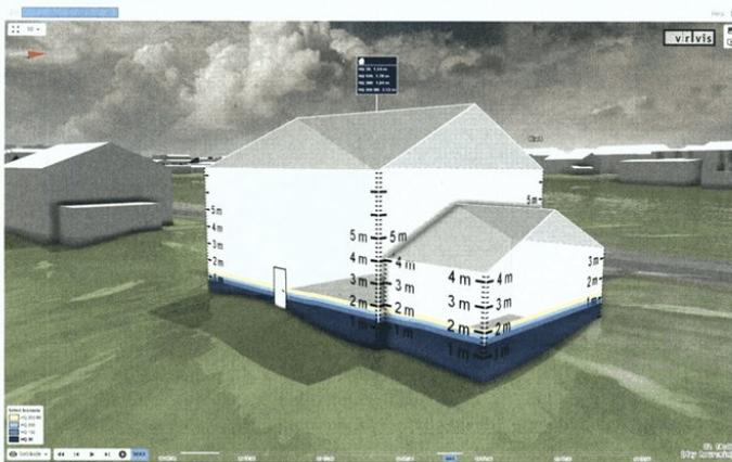
Abb. 4 Objektbezogene Risikovisualisierung mit den Anschlaglinien für vier Überflutungsszenarien entlang der Gebäudefassade (heller werdende Blautöne = HQ<sub>30</sub>, HQ<sub>100</sub>, HQ<sub>300</sub>; gelb = HQ<sub>300</sub> Restrisiko)
