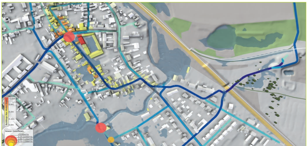
Starkregensimulation mit Kanalnetzkopplung.
