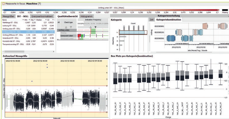
Analyse der Abweichung eines Qualitätsindikators vom Sollwert in unterschiedlichen Ansichten, z. B. über die Zeit, gemittelt pro Auftrag, Verteilung pro Charge etc.
